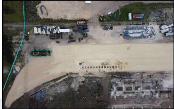
Ilustración 7 Descapote, excavaciones y movimiento de Tierra, Patio taller el Corzo - Octubre 2023 - Fuente: CIRO
