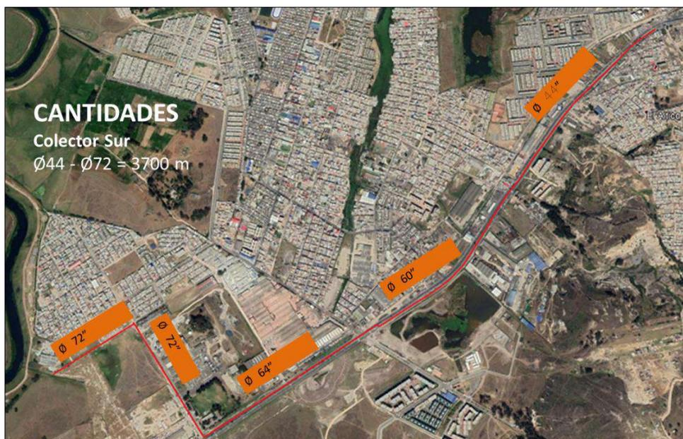
Ilustración 50. Colector Sur trazado, longitud y diámetro
